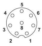
Kontaktbelegung der M12-Buchse
